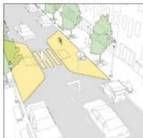
Figura 36 – Alcune soluzioni progettuali per aumentare il grado di sicurezza degli attraversamenti pedonali. Fonte: NACTO "Global Street Design Guide" (2016).
