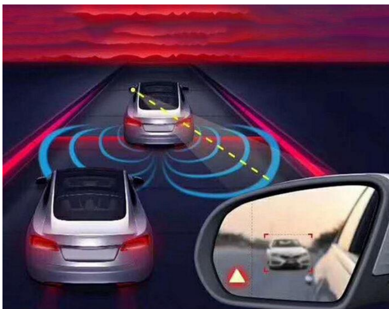
Figura 33 - Il BSM, sistema solutorio del problema dell'angolo cieco. Fonte: https://lcpshop.net .
