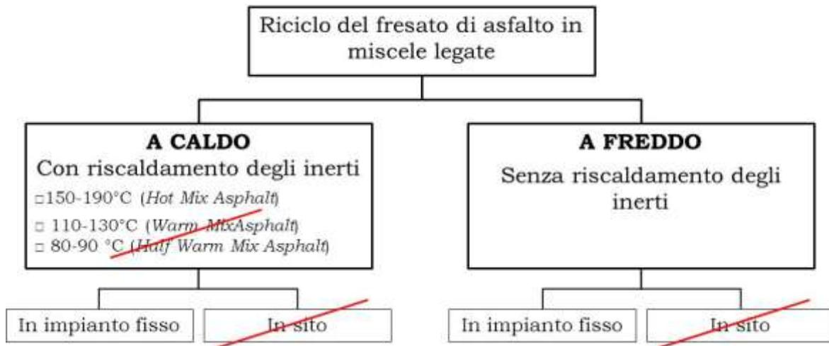
**Figura 13.** Classificazione delle diverse soluzioni tecnologiche per il riciclo del fresato proveniente dalle pavimentazioni ammalorate; sono mostrate barrate in rosso le modalità escluse dal presente studio di LCA.
