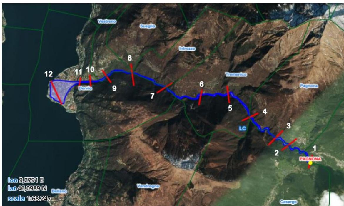
Figura 13 - Sezioni fluviali considerate nella simulazione idraulica di collasso.
