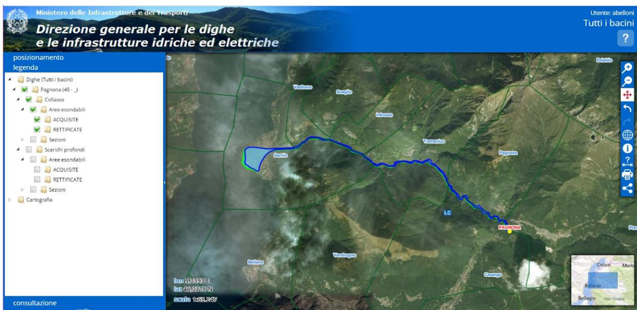
Figura 3 - Aree esondabili acquisite (blu) e rettificate (verde) conseguenti a ipotetico collasso della diga di Pagnona (LC).
