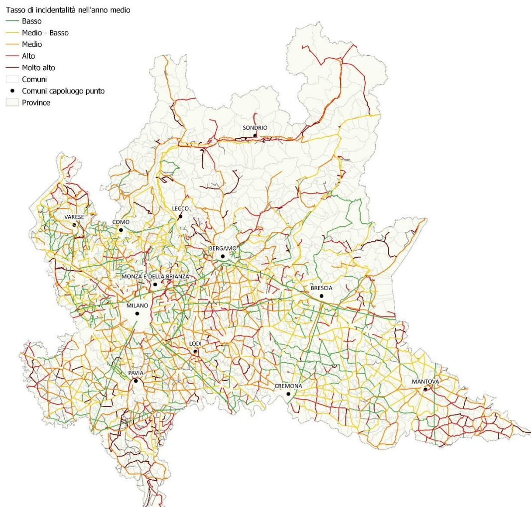
Figura 2 - Classificazione della rete stradale principale extraurbana di Regione Lombardia sulla base del Tasso di incidentalità. Elaborazione CeSCAM
